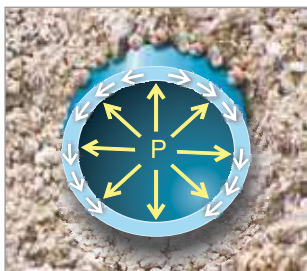
Фиг.: Вътрешно налягане – радиално натоварване на опън на стената на тръбата
